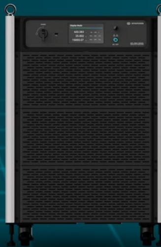
RPS-5000 再生电源系统提供 30 kVA 至 225 kVA 的高性能电力，集成了 AC/DC 电源、电子负载和电网模拟器于一体。凭借先进的波形谐波分析与模拟功能，确保精确、高效且可靠的电力测试。该系统专为 AI 服务器电源、新能源、电动汽车 (EV) 及电力电子领域设计，不仅符合 IEC 61000 合规要求，还通过双向再生设计提升测试灵活性与能源利用效率。
